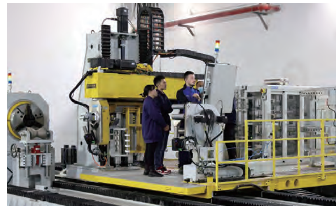
3月初起，纤维新材料研究院为了尽快推进数控卧式缠绕机设备投入运行，技术研发人员与厂家资深专家联手奋战10余天，完成设备安装调试，并开展实操培训。(邵波)
