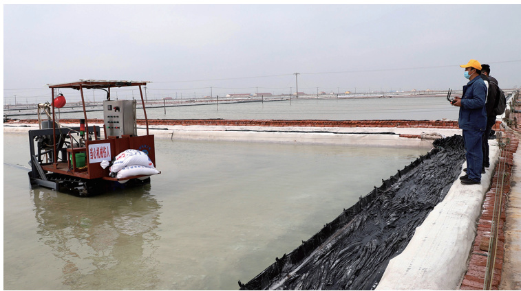
4月6日,日晒制盐公司“春耕”战役打响,在此次战役中,该公司新科技运用到扒盐中的又一力作——智能远程操控电动收盐机投入使用。“原先,无论风吹日晒,操作手只能‘死守阵地’,丝毫不能擅离岗位,现在不一样了,人在值班室喝着茶就能操作收盐机械,与之前相比,不仅节约成本,而且更安全也更舒适。”该公司机修工卢刚一边操作遥控器一边说道。(靳静)
